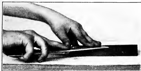
Fig. 111—Removing Wire Edge
